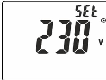
Fig. 6: Configuração da tensão nominal nas medições de Loop
