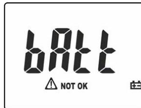
Fig. 45: Ecrã com indicação de bateria descarregada
