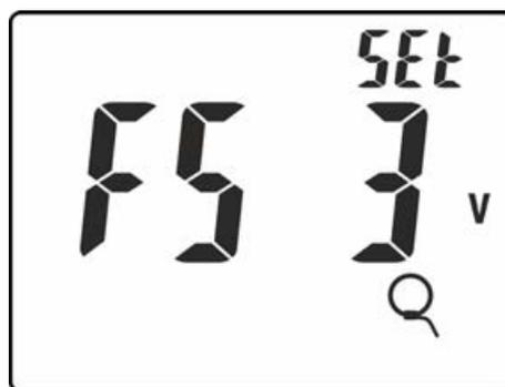
Fig. 7: Configuração do fundo de escala da pinça flexível
