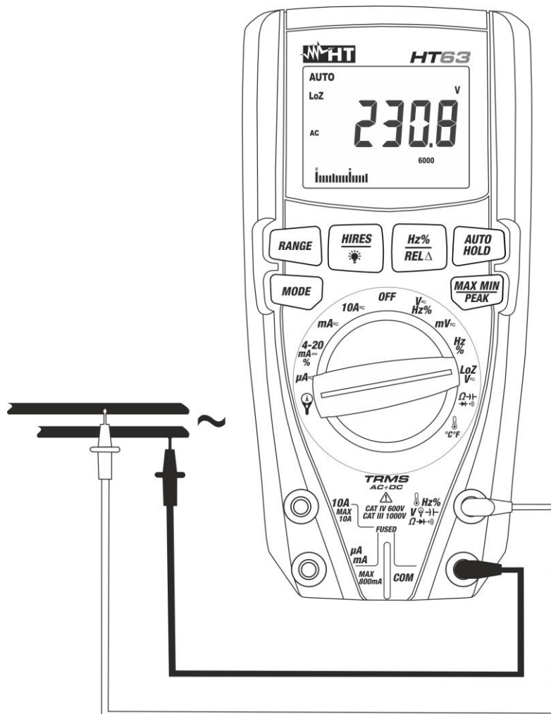
Fig. 4: Uso do instrumento para a medição de tensões CA/CC com função LoZ
