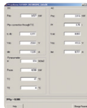
Esito collaudo fotovoltaico sull'applicazione PC TOPVIEW.
