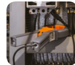
Misura di corrente di dispersione con pinza opzionale HT96U.
