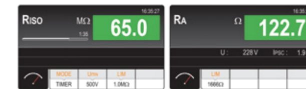
Misura di resistenza di isolamento.
