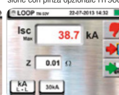
Esito negativo verifica del potere di interruzione.
