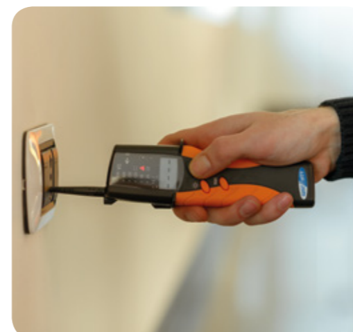
Funzione cercafase tramite pulsante conduttivo.
