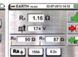
Esito OK misura resistenza di terra.
