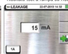
Misura della corrente di dispersione con pinza opzionale HT96U.
