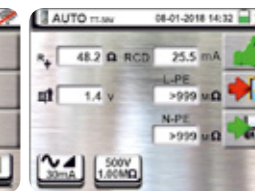
Autosequenza: sequenza automatica delle misure di Resistenza globale di terra, test RCD e Isolamento L-PE, N-PE.
