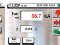
Advanced Loop: esito negativo verifica potere d'interruzione.
