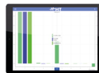
Esempio di visualizzazione Armoniche V-I
