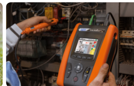
Start/stop misura con puntale remoto PR400.
