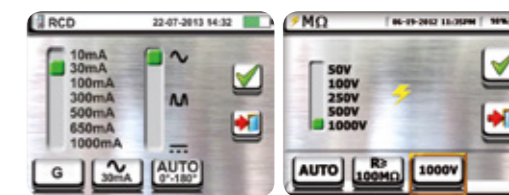
Selezione tipo e corrente di intervento RCD.
