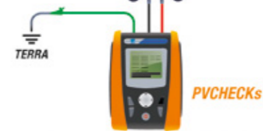
Misura di isolamento con modalità "intero campo fotovoltaico"
