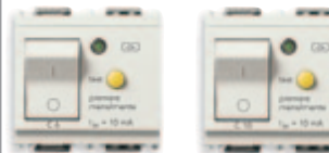
16511.06.B C 6, I_{\Delta n} 10 mA, poder de interrupção 1500 A - 2 módulos 16511.10.B C 10, I_{\Delta n} 10 mA, poder de interrupção 3000 A - 2 módulos
