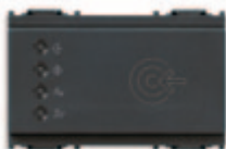
■ 16927 Leitor de cartões com transponder para instalação no exterior da sala, standard KNX, 2 saídas de relé NO 4 A 24 V~, 2 entradas, 12-24 V~ 50-60 Hz e 12-24 V d.c. (SELV) - 3 módulos. Fornecido sem cartão de transponder
