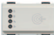
■ 16927.B Leitor de cartões com transponder para instalação no exterior da sala, standard KNX, 2 saídas de relé NO 4 A 24 V~, 2 entradas, 12-24 V~ 50-60 Hz e 12-24 V d.c. (SELV) - 3 módulos. Fornecido sem cartão de transponder
