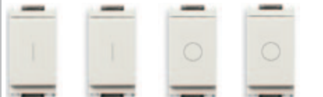
16101.B 1P NO 16 A, (marcha) 16107.B 1P NO 16 A, (marcha), contato auxiliar 16104.B 1P NC 16 A, (parada) 16110.B 1P NC 16 A, (parada), contato auxiliar
