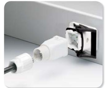
Die 4-adrige Rundleitung ist **dank Schneidklemm-Technik in wenigen Sekunden angeschlossen**: Es muss nur noch die Überwurfmutter auf die Leitung geschoben werden, denn der Spleißring, die Dichtung und die Zugentlastung sind in der Überwurfmutter enthalten.
