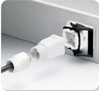
Die 4-adrige Rundleitung ist nun mit Schneidklemm-Technik in wenigen Sekunden angeschlossen: Es muss nur noch ein Teil - die Überwurfmutter - auf die Leitung geschoben werden, denn der Spleißring, die Dichtung und die Zugentlastungskrone sind mit der Überwurfmutter verbunden.
