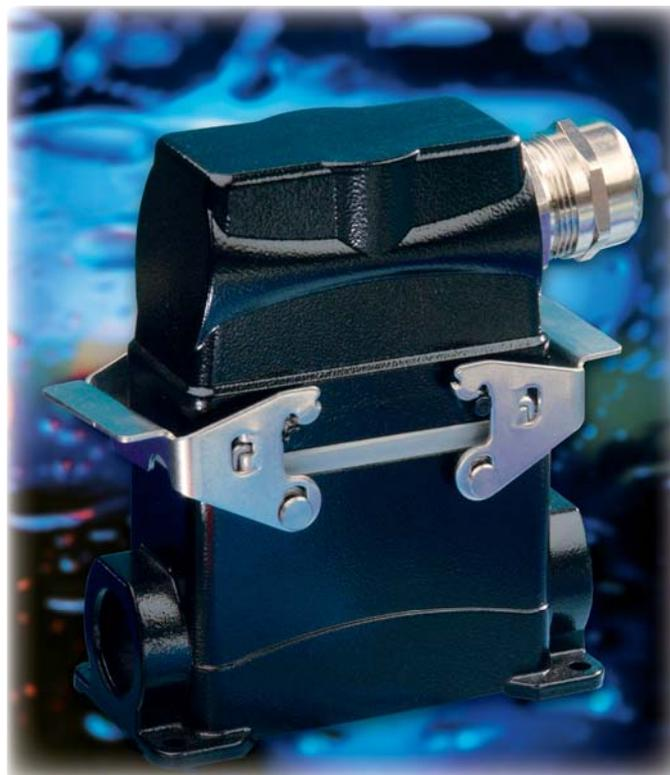
Die Gehäuse der Serie B HT sind aus einer seewasserfesten Spezial-Aluminium-Druckgusslegierung; die Dichtungen werden aus Viton gefertigt und sind bis 200 °C temperaturbeständig. Die Verriegelungseinheit besteht aus nichtrostendem Stahl.
