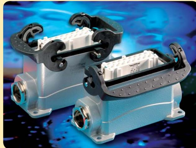
Kontaktträger der Serie DD können ausschließlich mit Crimpkontakten bestückt werden. Diese sind separat je nach verwendetem Leitungsquerschnitt zu bestellen und werden mit einer Crimpzange vercrimpt. Die Kontakte werden dann mit Hilfe des Montagewerkzeugs in den Kontaktträger eingerastet und mit dem Demontagewerkzeug bei Bedarf wieder gelöst.
