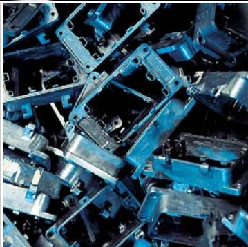
Fertig gegossene Anbaugehäuse
