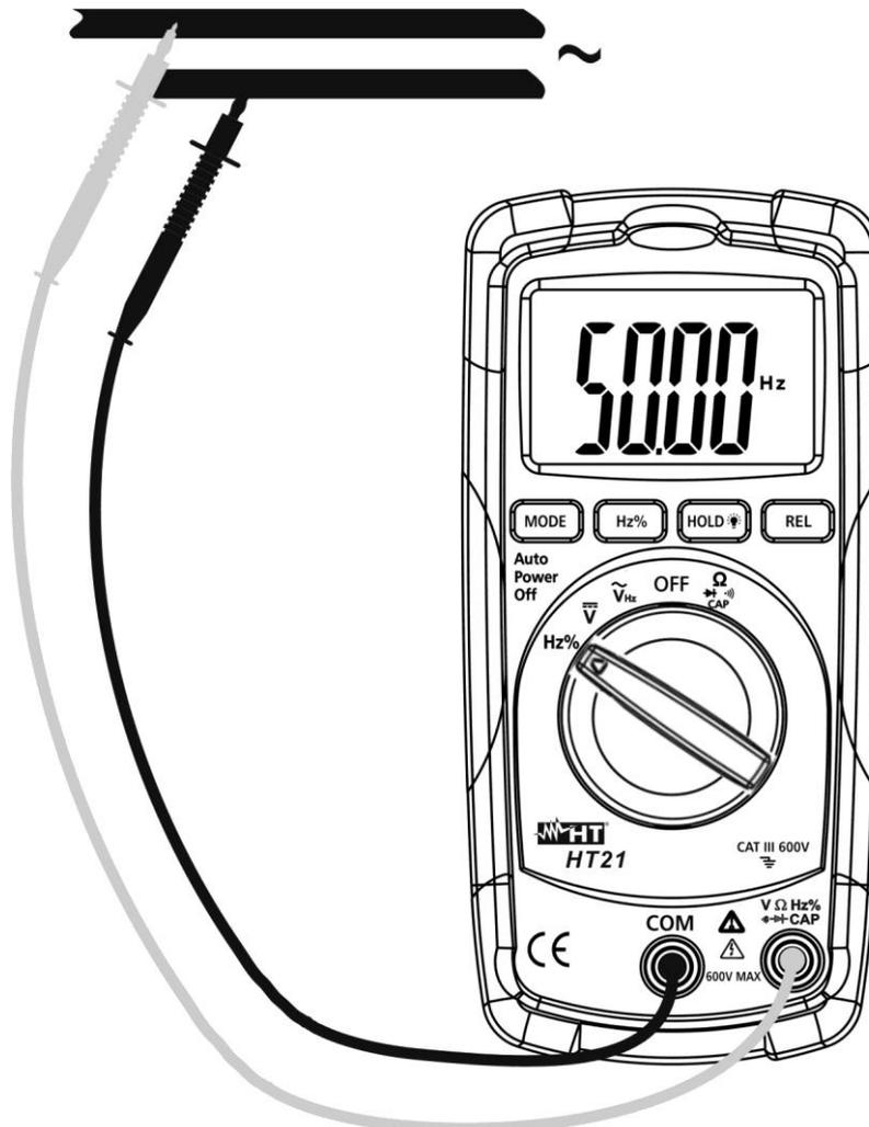
Fig. 6: Uso do instrumento para medir Frequências e Ciclo de Trabalho (Duty Cycle)
