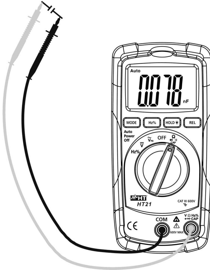
Fig. 7: Uso do instrumento para medir Capacidades
