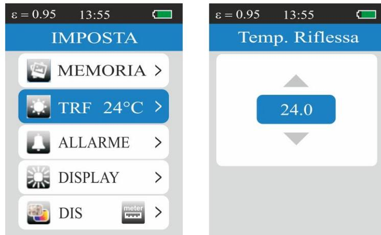
Fig. 13: Configuração da temperatura reflexa
