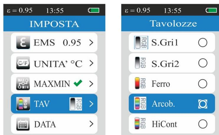
Fig. 9: Configuração da paleta de cores
