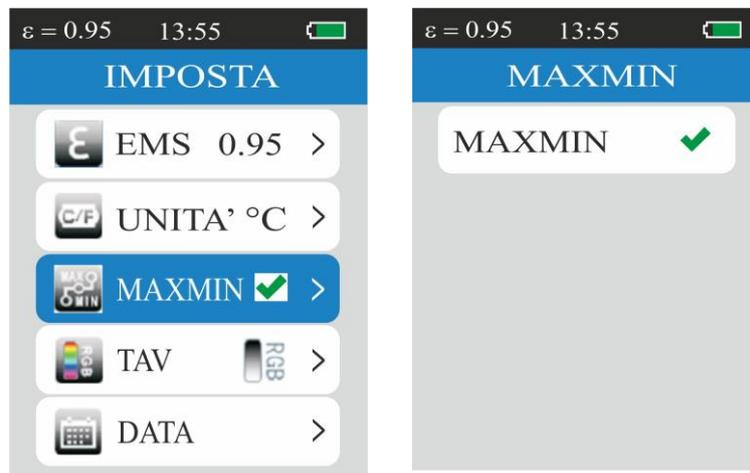
Fig. 8: Configuração da visualização MAX e MIN
