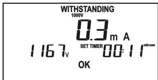
14. Caso contrário, se o valor medido for superior ao limite definido, o instrumento interrompe imediatamente a execução do teste, apresenta o resultado NÃO OK (NOT OK) e emite um sinal acústico prolongado.
