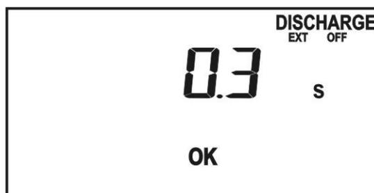
12. Caso contrário, se o valor medido for superior ao limite normativo (1 segundo) o instrumento apresenta o resultado NÃO OK (NOT OK) e emite um sinal acústico prolongado.
