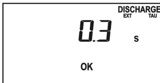
12. Caso contrário, se o valor do tempo de descarga for superior ao limite normativo (1 segundo) o instrumento apresenta o resultado NÃO OK (NOT OK) e emite um sinal acústico prolongado.
