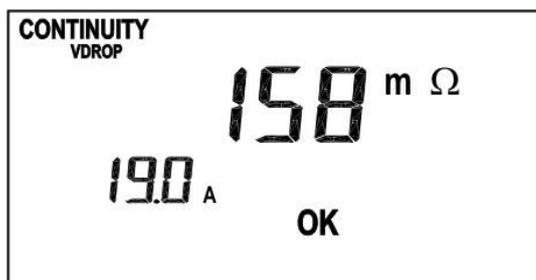
Caso contrário, se o valor da resistência medido for superior ao limite normativo, o instrumento apresenta o resultado NÃO OK (NOT OK) e emite um sinal acústico prolongado.
