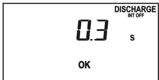
12. Caso contrário, se o valor medido for superior ao limite normativo (5 segundos) o instrumento apresenta o resultado NÃO OK (NOT OK) e emite um sinal acústico prolongado.
