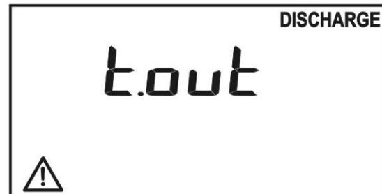
3. Quando a retirada da alimentação do dispositivo em teste acontece enquanto o valor da tensão instantânea presente nas extremidades dos terminais de medida não está dentro dos limites previstos, o instrumento apresenta o ecrã mostrado ao lado.
