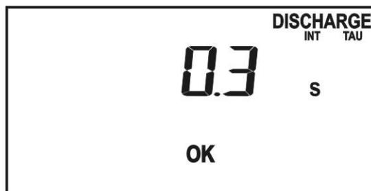
12. Caso contrário, se o valor do tempo de descarga é superior ao limite normativo (5 segundos) o instrumento apresenta o resultado NÃO OK (NOT OK) e emite um sinal acústico prolongado.
