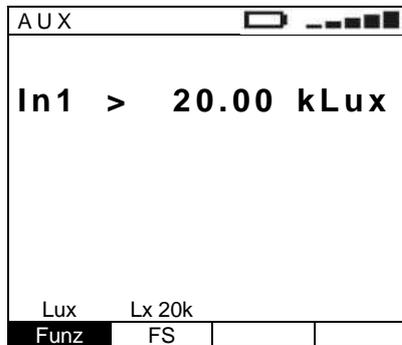
Valor detetado superior ao fundo da escala do instrumento
