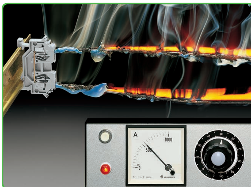
Tipo de teste: "Teste de Resistência da Corrente de Curta-duração"
