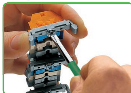
Régua de bornes com flanges de fixação, montagem com parafuso do adaptador de montagem 209-123 (a distância entre os adaptadores de montagem deve ser 35-40 mm).
