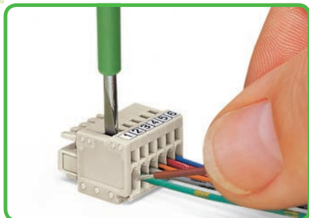
Inserir condutor com a chave de fendas (2,5 x 0,4) mm. Operação perpendicular à entrada do condutor.
