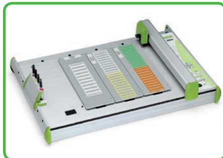
Marcação através de plotter IP 350.
