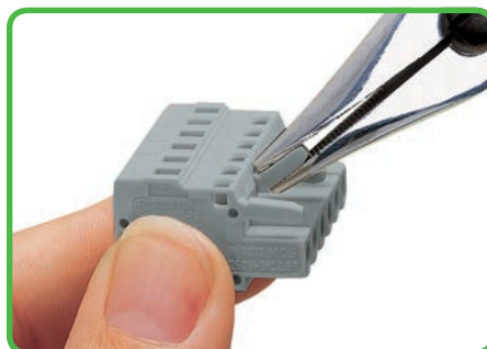
Codificação de um conector fêmea - remoção do(s) pino(s) de codificação.
