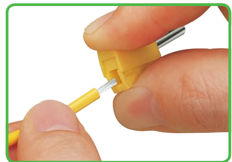
Terminação do condutor: Pressione totalmente o botão e insira o condutor descarna- do na entrada quadrada, libertando-o em seguida.
