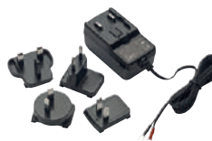
40104 Fonte de alimentação, 100-240 Vac 50/60 Hz, ficha permutável 2P com especifica- ções europeia, britânica, americana e australiana, 24 Vdc
