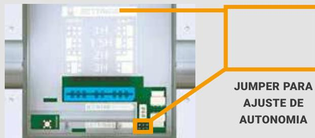
JUMPER PARA AJUSTE DE AUTONOMIA
