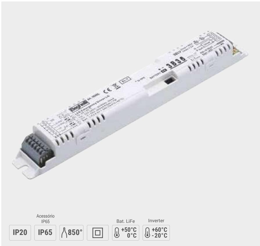
Inverter LED de alto desempenho com controlo de corrente constante na saída em PWM, para um funcionamento ótimo do LED sem distorção do fluxo luminoso e da temperatura de cor.
