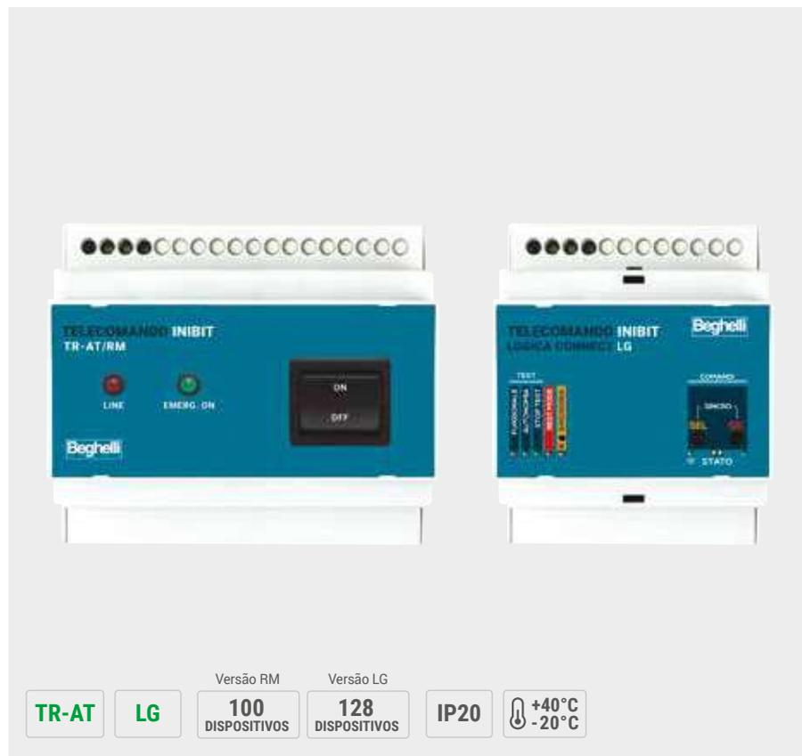
Unidade de telecomando Inibit para controlo da inibição do sistema de emergência (função Modo de repouso). A ligação é feita através de BUS de 2 fios. Disponível para a versão LG (4 módulos DIN) e para a versão TR/AT (6 módulos DIN)
