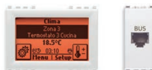
21509.B Unidade de controlo para controlo e configuração, entrada de sensor de temperatura, fornecida com armação V51923 para instalação em calha DIN (60715 TH35), 3 módulos - branco. Fornecido com conetor RJ45 e moldura V51921. Profundidade: 37 mm
