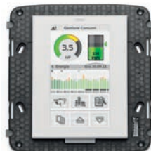
21511.1.B Full Flat 4,3", para controlo, sensor de temperatura entrada, com caixa de montagem de 8 módulos incorporada, branco. Profundidade: 39,9 mm
