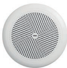
01906 Altifalante passivo IP55, 8 Ω 30 W, para paredes ocas e instalação em tetos falsos. Profundidade: 70 mm
