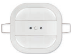
01527 Detetor de presença IR, amplitude de movimento 360°, ON/OFF, ajuste de iluminação, aquecimento, ar condicionado, ventilação, ajustável de 1-1000 Lux, norma KNX, para instalação no teto. Dimensões: 80x80x45 mm
