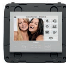
21554.BN Full Flat 4,3", para sistema e controlo de videoporteiro Due Fili Plus, entrada de sensor de temperatura, com caixa de montagem de 8 módulos incorporada, neutra. A ser completada com espelhos Eikon, Arké ou Plana. Profundidade: 46,7 mm
