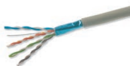
03061.E Cat. 5e Cabo F/UTP, blindado, 4 pares, 24 AWG, LSZH-sheath, classe CPR Eca, adequado para cabos da categoria I (U0 = 400 V), cinzento - 305 m
