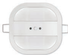
01529.1 Detetor de presença IR, alcance de movimento 360°, para iluminação ON/OFF, ajustável 1-1000 Lux, standard KNX, para instalação no teto. Dimensões: 91x91x45 mm
