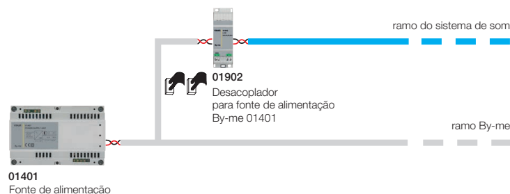
Exemplo 1: sistema de som no mesmo ramo lógico (Área/Linha), mas com cablagem separada.
