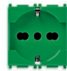
14210.AB.V SICURY 2P+E 16 A 250 V~- tomada universal, verde - 2 módulos. Profundidade: 25 mm
