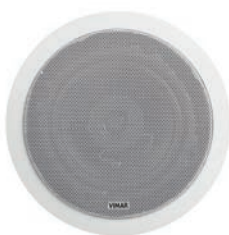
01907 Altifalante passivo, 8 Ω 30 W, para paredes ocas e instalação em tetos falsos. Profundidade: 68 mm
