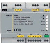
01465 Dispositivo de controlo climático para sistemas de aquecimento, fonte de alimentação 120-230 V~ 50/60 Hz, 3 entradas para sondas PT100, PT1000 e NTC, 1 saída de controlo de válvulas mis- turadoras, 1 0-10 V ou (0) saída de 4-20 mA, 1 saída de relé de 16 A 230 V~ comutador, módulos de 6 x 17,5 mm
