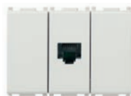
14505.AB Módulo de relé com tomada RJ45 para cabo comando de chamada com 2 luzes + 2 AUX, ligação com um módulo 8IN/8OUT ou um ecrã de Call-way, 4 saídas de relé 24 V NO, tratamento antibacteriano - 3 módulos. Profundidade: 29,5 mm
