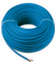
01840.E.B Sistema By-me system Cabo de Bus para sistema de som, 2x0,50 mm 2 , com revestimento LSZH, classe CPR Eca, adequado para cabos da categoria I (U0 = 400 V), azul - 100 m
