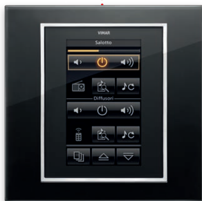
Ecrã Full Flat tátil a cores 4.3" com visualização de "gestão do sistema de som" localizado na sala
