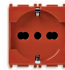
14210.AB.R SICURY 2P+E 16 A 250 V~- tomada universal, vermelho - 2 módulos. Profundidade: 25 mm
