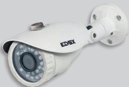
Câmara externa Bullet AHD, Full HD 1080p, com objetiva fixa de 3,6 mm e grau de proteção IP66. A câmara deve ser alimentada com um dos alimentadores disponíveis, entre os standards UE, US, AU, BS.
