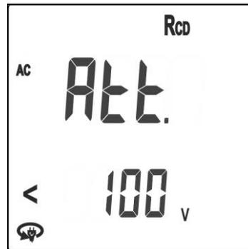
Esta condição pode verificar-se, a título de exemplo, quando o cabo preto está ligado erradamente ao condutor do neutro em vez do condutor de fase. Quando se utiliza um cabo shuko rodar a ficha e repetir o teste.
