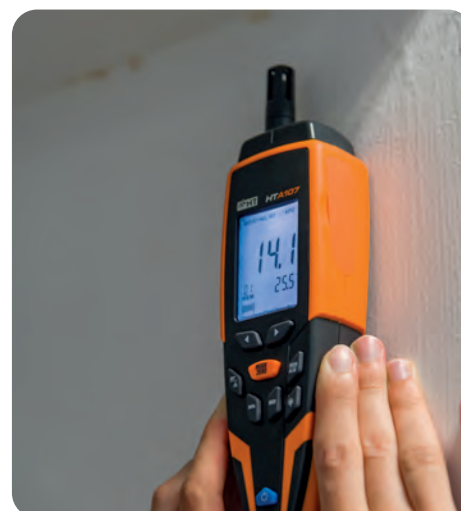
Medição de humidade em materiais com sensor integrado do HTA 107 (Foto: medição direta numa parede aparentemente húmida)
