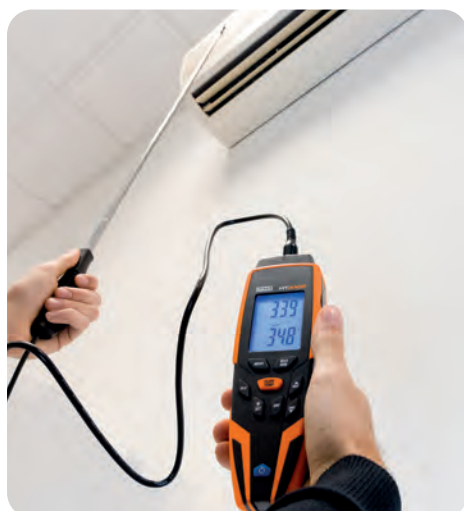
Medição da velocidade e temperatura do ar com sonda telescópica de HTA105
