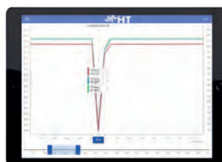
Visualização da gravação efetuada (Evidentes interrupções de tensão)
