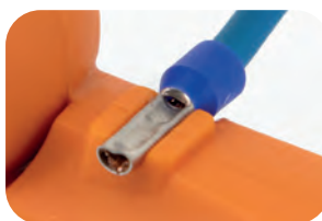
Ponteira de 1.5mm 2 cravada com F30
