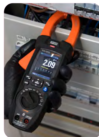
Medição da Corrente AC.
