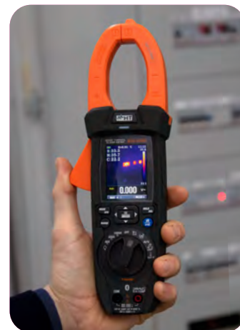
Verificação termográfica com ponteiro laser
