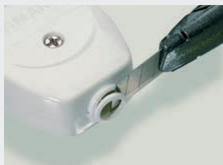
Codulo integrato sezionabile con cutter (diametro massimo del foro 10 mm per presa 10 A, o 11 mm per presa 16 A)
