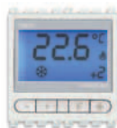
19430.B Termostato elettronico per controllo temperatura ambiente di 2 zone indipendenti, standard KNX, 1 uscita a relè NO 4 A 24 V~, 1 ingresso per sensore di temperatura 19432, 1 ingresso digitale programmabile - 2 moduli
