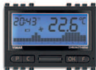
19446 Uscita relè in scambio 5(2) A 250 V~, batterie stilo AA LR6 1,5 V (in dotazione) - 3 moduli
