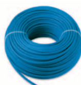
01840.B Cavo per diffusione sonora, esente da alogeni 2x0,50 mm², 400 V, idoneo per installazione con cavi energia di I Categoria, blu - 100 m
