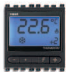
19430 Termostato elettronico per controllo temperatura ambiente di 2 zone indipendenti, standard KNX, 1 uscita a relè NO 4 A 24 V~, 1 ingresso per sensore di temperatura 19432, 1 ingresso digitale programmabile - 2 moduli
