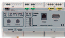
Δ 01941 Comunicatore telefonico GSM, 2 canali di uscita 2 canali d'ingresso, 120-230 V~ 50-60 Hz
