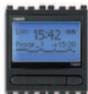
19448 Programmatore giornaliero/settimanale, 1 canale, uscita relè in scambio 8 A 230 V~ - 2 moduli
