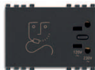
19290 230 V~ 50-60 Hz, con trasformatore di isolamento 20 VA, uscite 230 V~ e 120 V~ - 3 moduli
