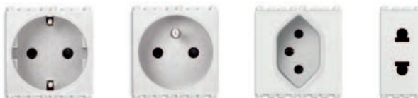
19208.B SICURY 2P+T 16 A, standard tedesco - 2 moduli 19212.B SICURY 2P+T 16 A, standard francese - 2 moduli 19226.B 2P+T 10 A, tipo 13, standard svizzero - 2 moduli 19234.B SICURY 2P 16 A, standard euroamericano (ø 4,8 mm)
