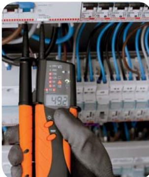
Medição de Tensão com visualização valores dos LEDs e Display.
