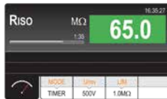
Medição da resistêmbia de isolamento
