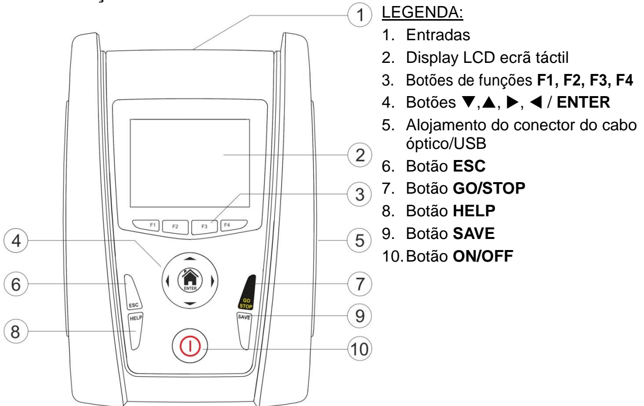
Fig. 1: Descrição da parte frontal do instrumento
