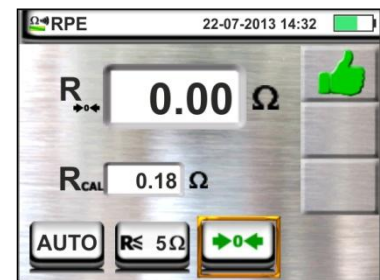
Fig. 7: Compensação da resistência dos cabos individuais e da ponteira remota
