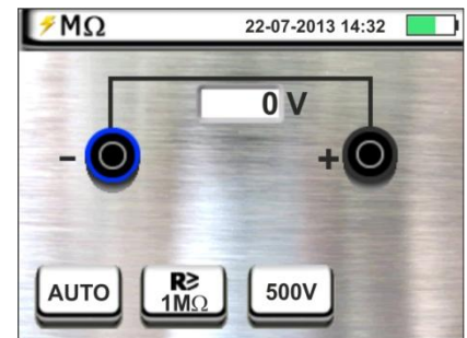
Fig. 9: Verificação do isolamento entre fase e terra através de ficha shuko
