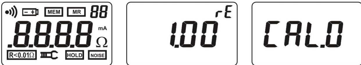
Fig. 2: Sequência dos ecrãs apresentados no display ao ligar o instrumento
