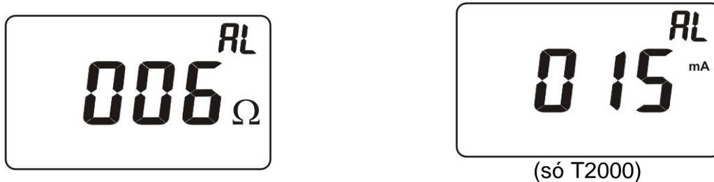
Fig. 39: Configuração dos patamares de alarme para medição de resistências e Correntes
