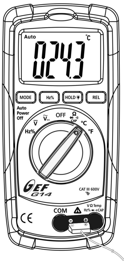
Fig. 8: Uso do instrumento para medir Temperaturas
