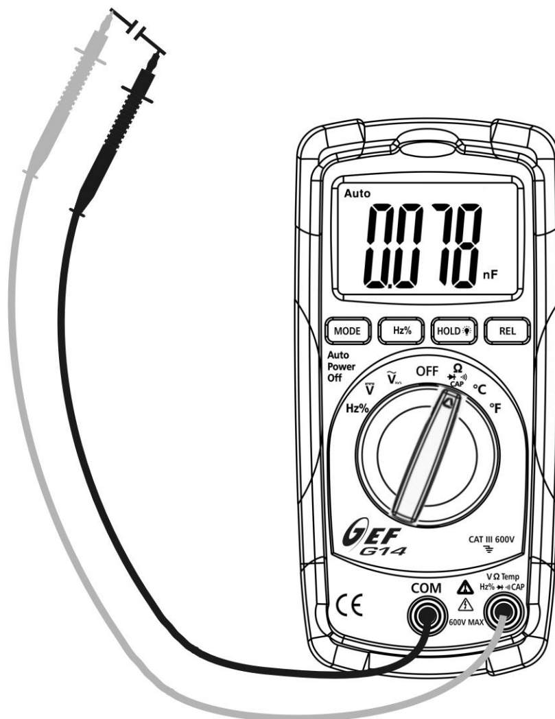
Fig. 7: Uso do instrumento para medir Capacidades
