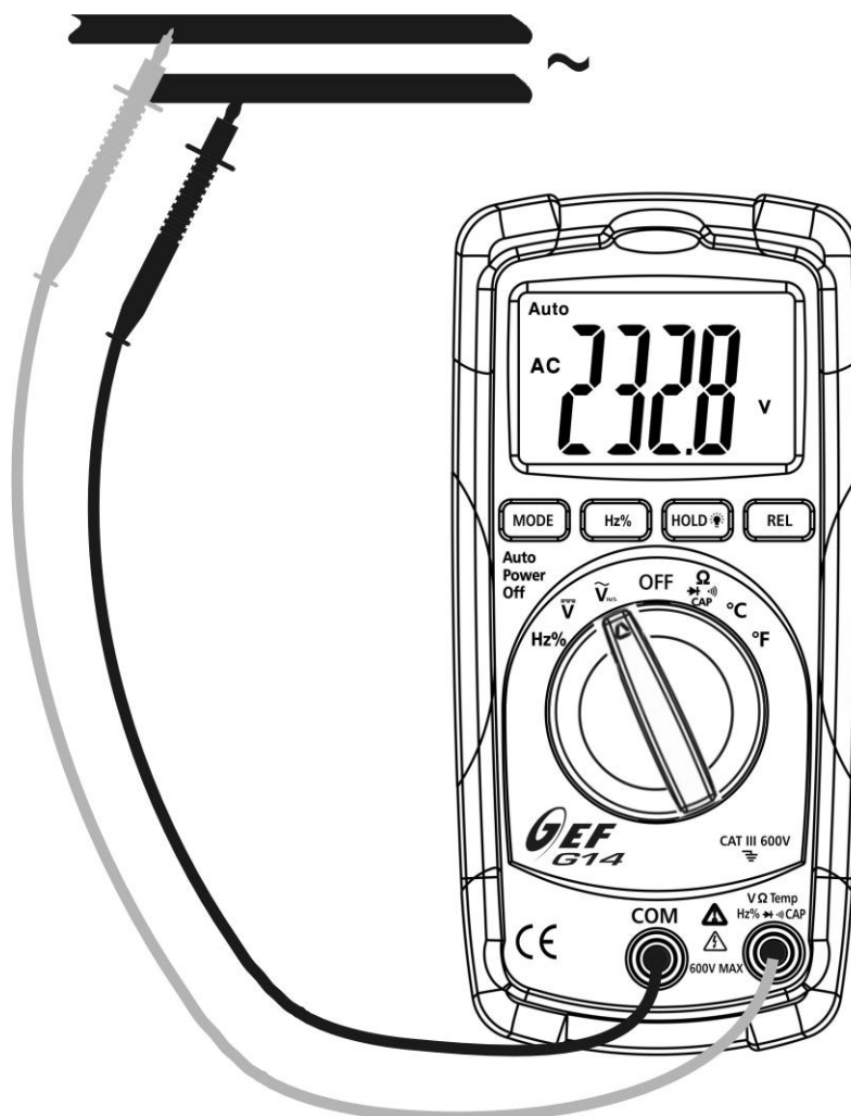
Fig. 3: Uso do instrumento para medir Tensões CA
