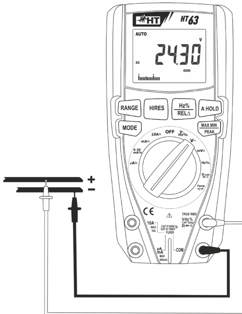
Fig. 2: Uso do instrumento para a medição de Tensões CC
