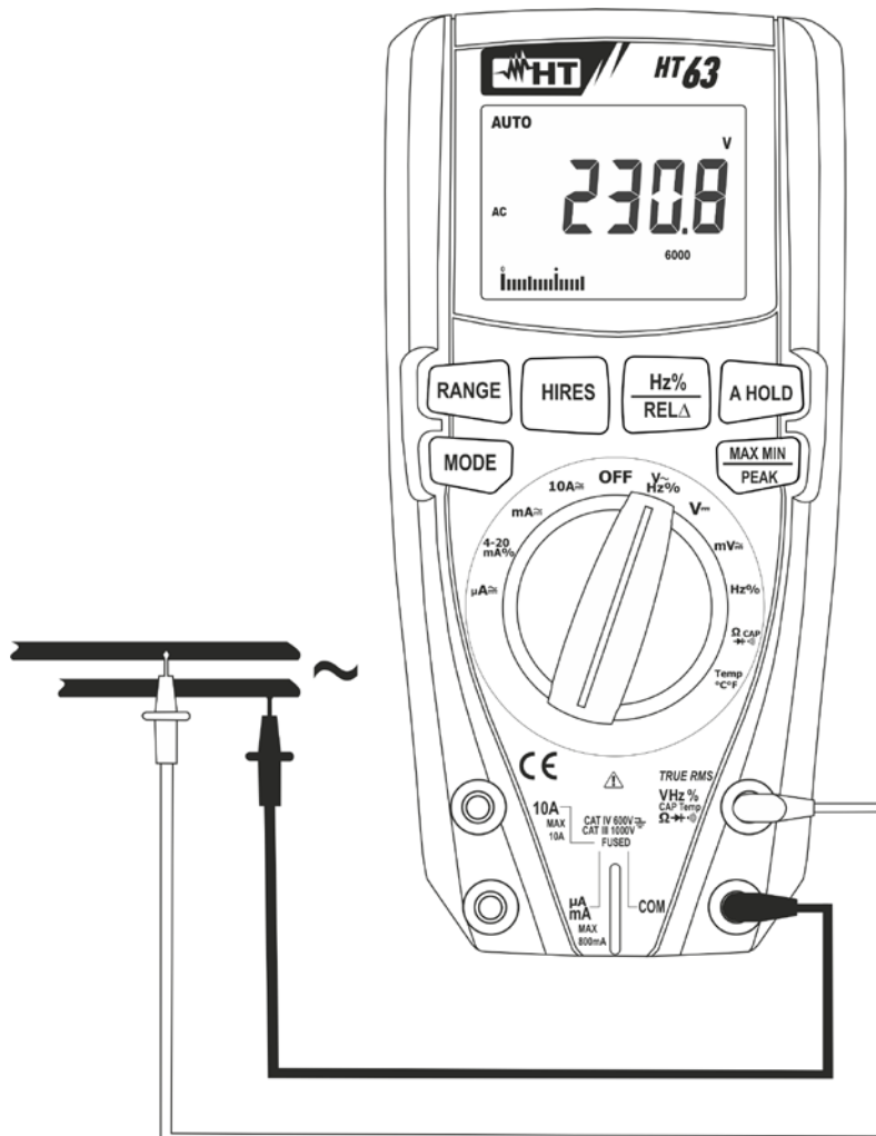
Fig. 3: Uso do instrumento para a medição de Tensões CA
