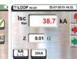
Esito negativo verifica del potere di interruzione
