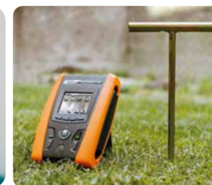
Misura della resistenza di terra con metodo voltamperometrico.
