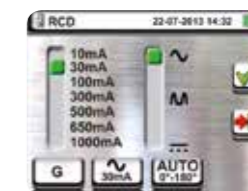
Selezione tipo e corrente di intervento RCD
