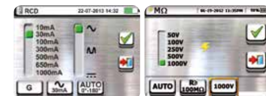
Selezione tipo e corrente di intervento RCD
