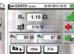
Esito OK misura resistenza di terra.
