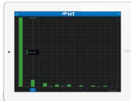
Armoniche di corrente e tensione.
