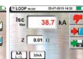
Advanced Loop: esito negativo verifica potere d'interruzione.
