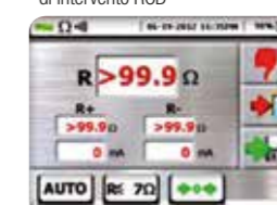
Continuità conduttori di protezione: Esito risultato di misura negativo
