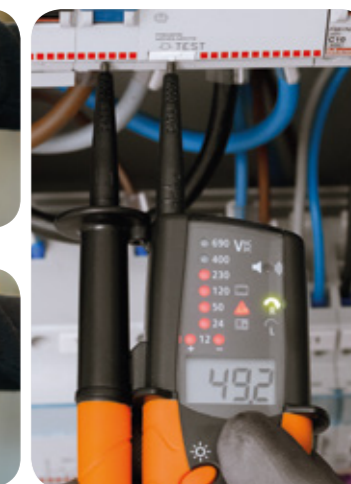
Misura del senso ciclico delle fasi.
