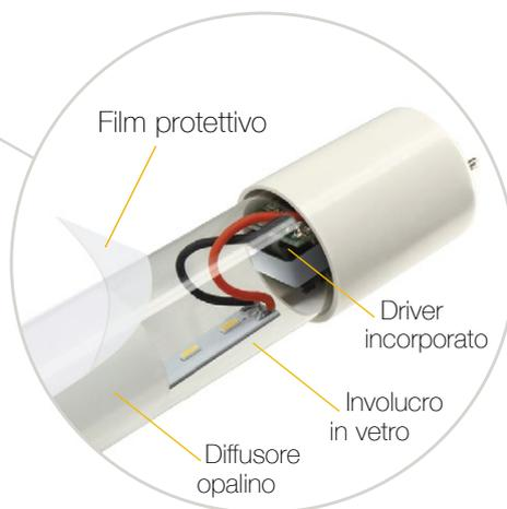
L'involucro completamente in vetro, abbinato al diffusore opalino contenuto all'interno, permette una diffusione della luce con un ampio angolo di 270° e consente di sfruttare le parabole degli apparecchi.
